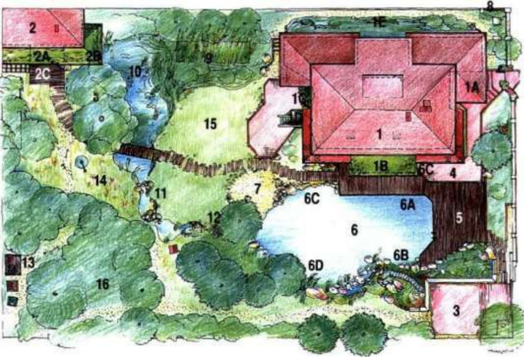
Der Schwimmteich (6) hat einen Skimmer, einfache Filterkammer, Hydrobotanik und eine Flow-forms Kaskade .
