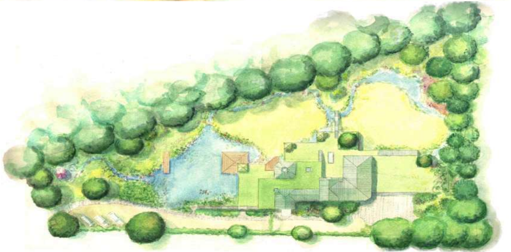
Eine ca. 350m 2 große Teichanlage bei Warschau. Das Regenwasser vom Gründach wird über einen, dicht bepflanzten Bachlauf in den Teich geleitet. Die Bachläufe gehören zum Filtersystem und werden permanent mit dem Teichwasser gespeist.
